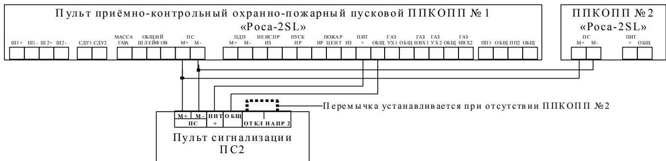
Рисунок 9. Подключение ППКОПП «Роса-2SL» к пульту сигнализации ПС2.
