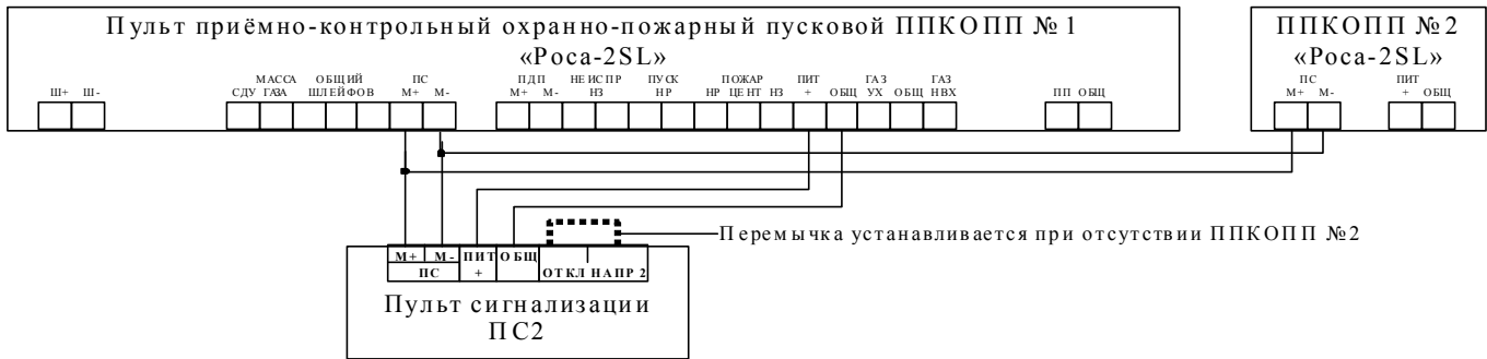
Рисунок 9. Подключение ППКОПП «Роса-2SL» к пульту сигнализации ПС2.
